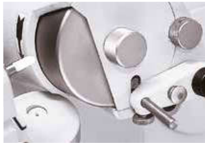
Abrichten bei geschlossener Schutzhaube
